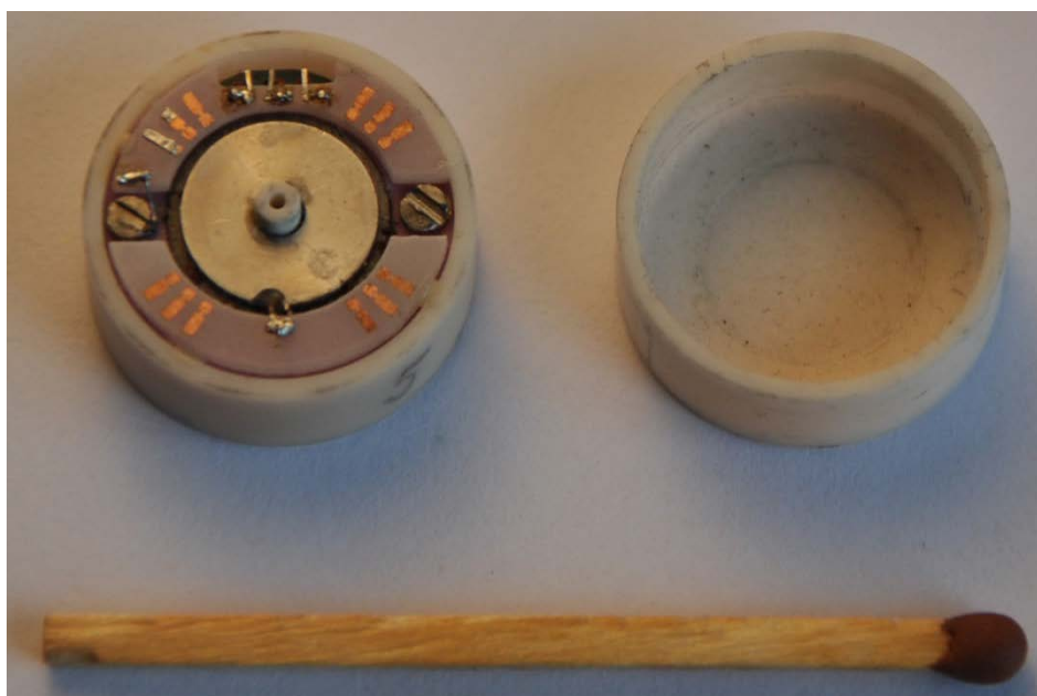
Рис. 10. Внешний вид макета акселерометра.
